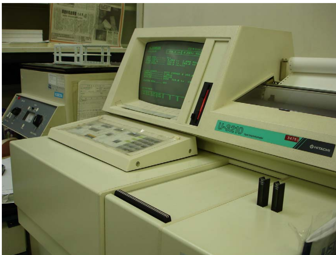
圖五、可疑成分以 95%乙醇溶解離心，取上清液用紫外光可見光分光光度計檢測其吸收光譜。
